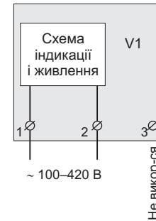
Схема 1. Спрощена внутрішня схема і схема підключення
