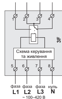
Схема 1. Спрощена внутрішня схема і схема підключення
